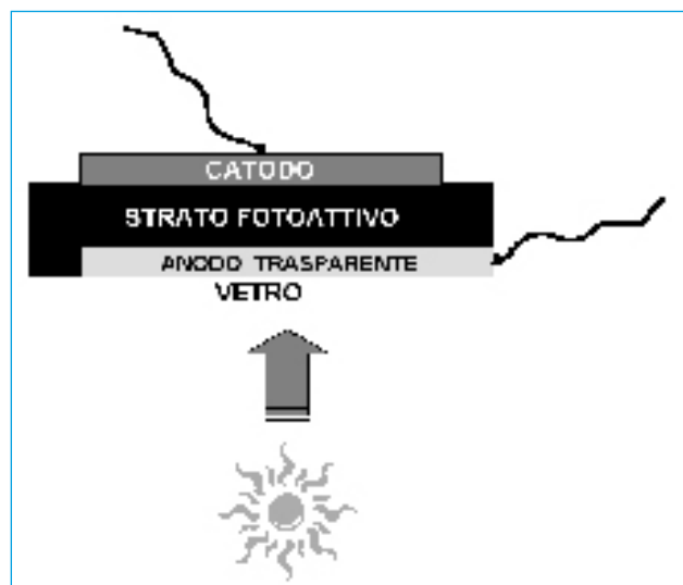
Figura 1: Schema semplificato di una cella fotovoltaica organica.
