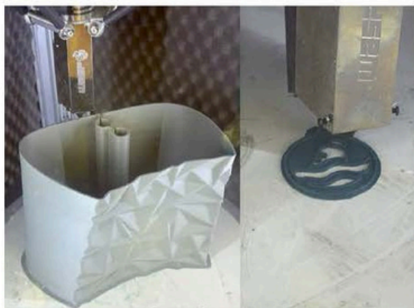
Figura 2: Esempi di manufatti ottenuti mediante stampa 3D a partire da granuli di MPO additivati.
